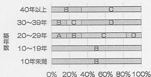
図 8 外壁の築年数別劣化状況
