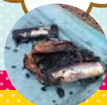
▲発火後のリチウムイオン電池
