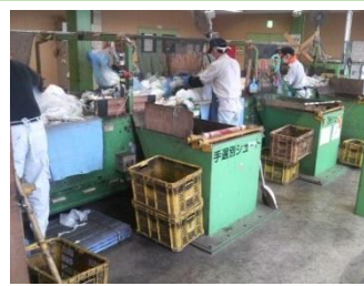
手選別コンベア作業 (民間処理施設)
