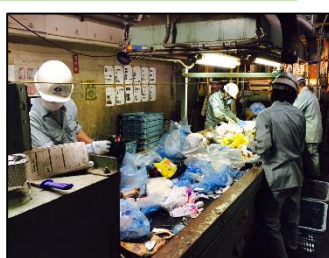
手選別コンベア作業 (現中間処理場)
