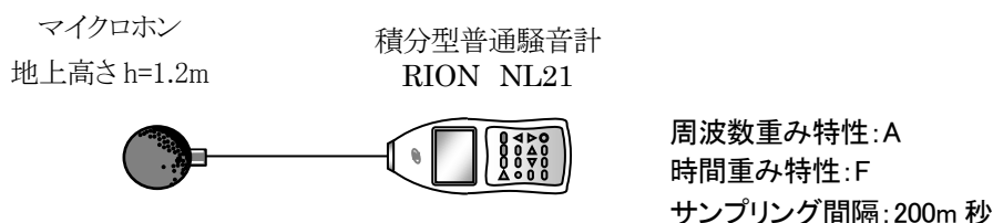
図 2.3 測定機器の構成図(騒音レベル)
