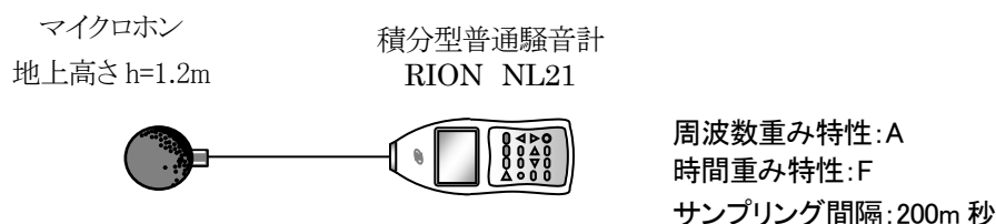
図 2.3 測定機器の構成図(騒音レベル)
