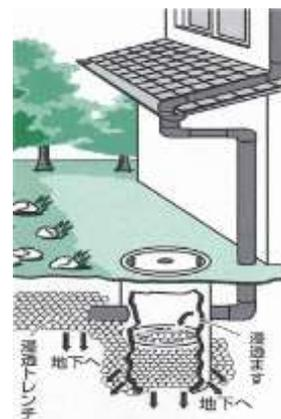
図-12 雨水浸透ますの設置例(左)と概念図(右)
