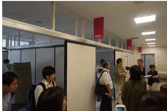
④ 2階 相談室（健診会場） 1から5までの相談室は可動間仕切りで一体利用可能。新型インフルエンザなど感染力の高い疾病の際に陰圧エリアの設定し、感染の拡大を防ぐ。
