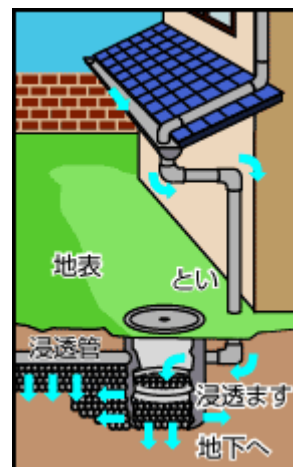
■図6-3 雨水浸透ます設置のイメージ
